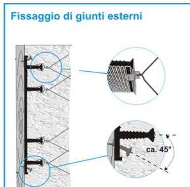
I giunti esterni per pareti vanno fissati sull'area terminale alla cassaforma con chiodi. Le ancore di bloccaggio vanno fissate in posizione stabile all'armatura mediante fermagli per giunti. Nella posa orizzontale i giunti esterni vanno fissati sul getto di pulizia.
